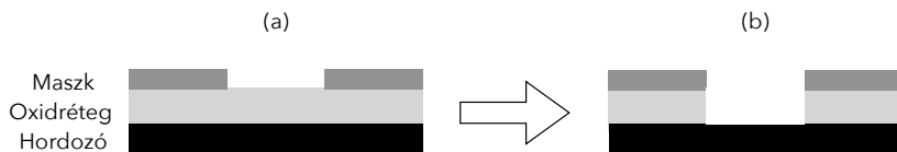
12.12. ábra. Példa félvezető struktúra kialakítására. A hordozó anyaga Si, ennek felületén egy oxidréteg ( \text{SiO}_2 ) található, e fölé egy maszk kerül kialakításra (a). A marási folyamat célja az oxidréteg eltávolítása a maszk által nem takart felületről (b).
