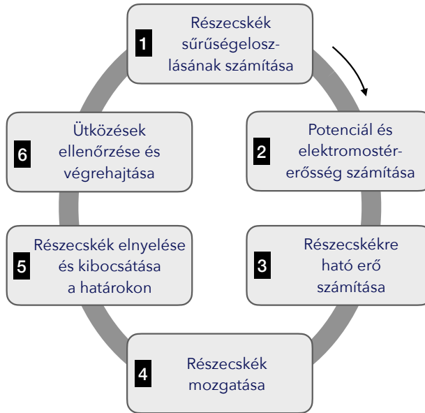
9.5. ábra. Az elektrosztatikus PIC/MCC módszer alaplépései [84]. (A CC BY 4.0 licenc alapján reprodukálva és magyarra fordítva az alábbi cikkből: Z. Donkó, A. Derzsi, M. Vass, B. Horváth, S. Wilczek, B. Hartmann, P. Hartmann: eduPIC: an introductory particle based code for radio-frequency plasma simulation, Plasma Sources Science and Technology 30, 095017 (2021), https://doi.org/10.1088/1361-6595/ac0b55 .)
